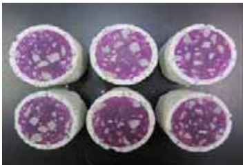
ハレーサルト 普通コンクリート 5%硫酸水溶液浸せき後（119日間）の供試体
