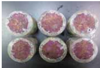
ハレーサルト 普通コンクリート 5%硫酸水溶液浸せき後（119日間）の供試体
