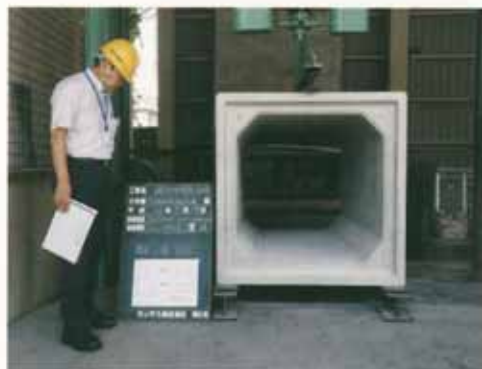
写真－3 立会試験での品質確認状況
