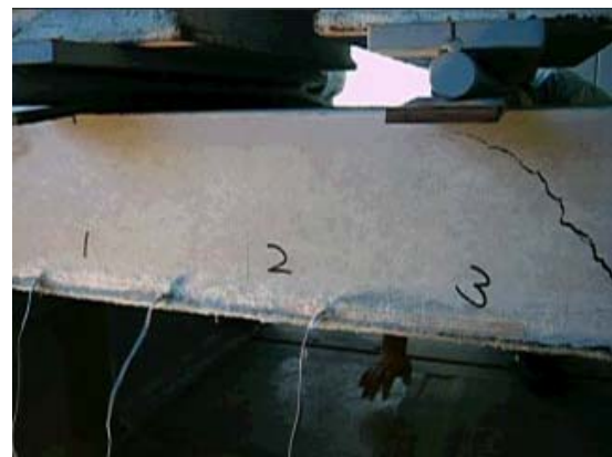
写真-5 FRP ライニング型の破壊状況
