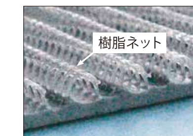
【GSボードの裏面】 樹脂ネットによりコンクリートとの付着力を強化。
